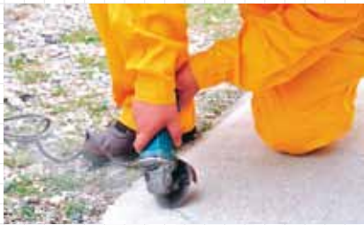
เวลาใช้ส่วน ให้เอามือข้างที่ถนัด จับส่วนหน้าไว้ให้แน่น ส่วนมืออีกข้างประคองปลายด้านที่มีสวิตช์ไว้ อุปกรณ์นี้อันตรายจะต้องใช้อย่างระมัดระวัง
